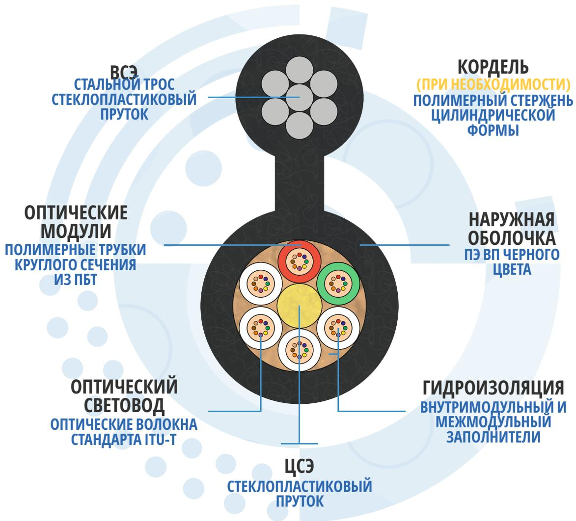
**НАЗНАЧЕНИЕ:** для подвески на опорах воздушных линий связи, столбах городского освещения, опорах радиотрансляционной сети, между зданиями и сооружениями
